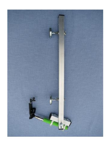
Bei der Auslieferung sind die beiden Magnete so angeschraubt, dass der Abstand zwischen Quadratrohr und Magnetfläche exakt gleich ist und ca. 42 mm beträgt. Damit kann die Halterung in jeder Position *magnetisch* an der Rückseite der Weißwandtafel *angeheftet* werden.
