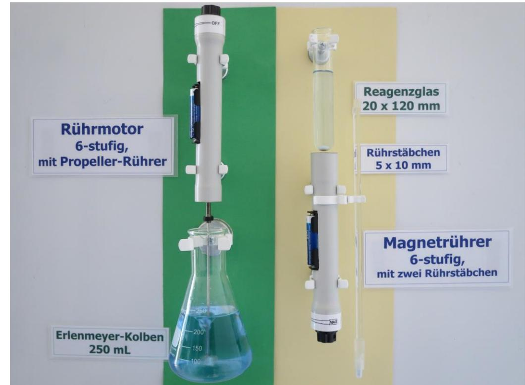
Das Batteriefach ist bewusst außen angebracht; sodass die Batterie (AA 1,5 V) leicht eingesetzt und – bei längerem Nichtgebrauch - entnommen werden kann. Sollte die Batterie auslaufen, ist eine Beschädigung des Motors nicht möglich.
