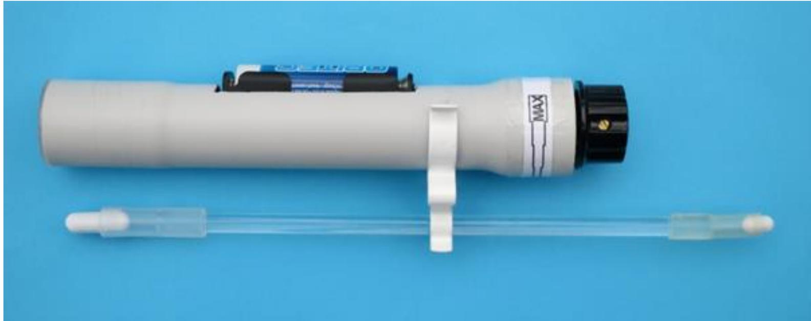
Der kleine Rührfisch kann in Reagenzgläsern (z.B. 16 x 180 mm, 20 x 120 mm oder 30 x 200 mm) eingesetzt werden, ebenso in kleinen Erlenmeyerkolben.
