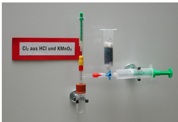
Absorptionsröhrchen in einer Chlorapparatur
