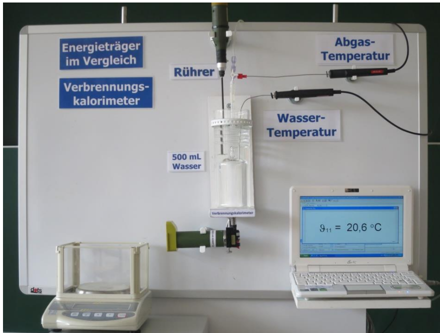
Abb. 1: Versuch 21.3 Messung der Wasser- und Abgastemperatur mit zwei Thermofühlern
