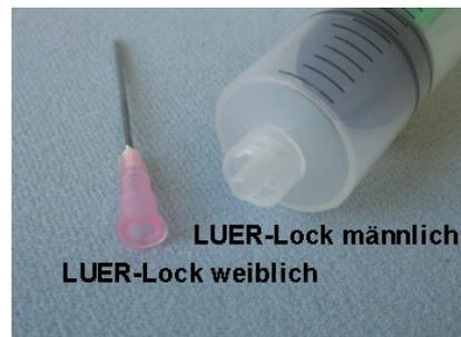
Der Luer-Lock Verschluss hat noch einen weiteren Vorteil. Man kann über ihn ein Stückchen Silikon-schlauch ziehen, so dass eine Verbindung zu üblichen Glasrohren ( $d = 8 \text{ mm}$ ) geschaffen wird.
