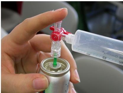
Gasentnahmemöglichkeit mit DWH
