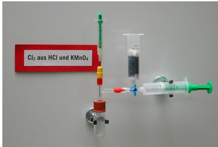
Absorptionsröhrchen in einer Chlorapparatur
