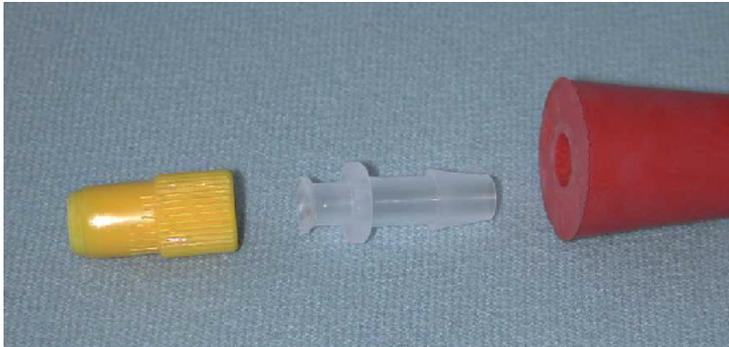
Manchmal ist es notwendig Spritzen direkt miteinander zu verbinden. Hierzu eignen sich Adapter vom Typ w-w. Auch die Gegenstücke m-m finden in einigen Versuchsaufbauten Verwendung.
